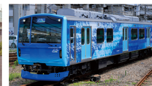
燃料電池を搭載した試験用電車 © 東日本旅客鉄道(株)
